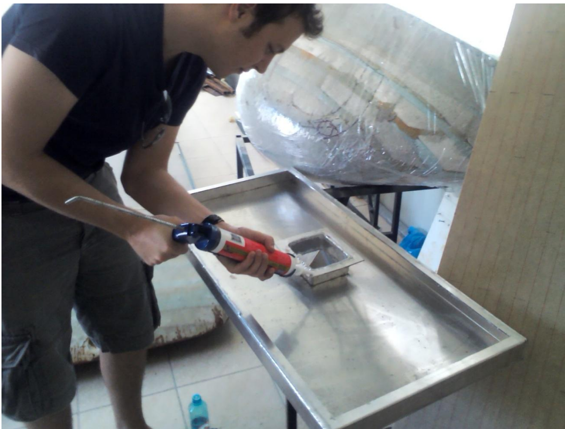
Εικόνα 4.1.3. Οπίσθια όψη κεντρικού κουτιού διαστάσεων 90 cm x54 cm x5cm και εργασία κόλλησης.
