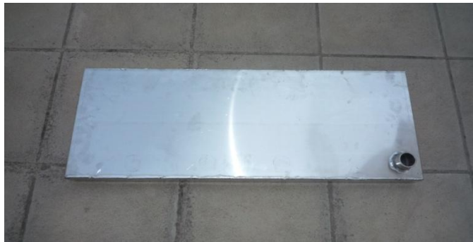
Εικόνα 4.1.1: Εμπρόσθια όψη αλουμινένιου κουτιού 90 cm X46 cm X5 cm
