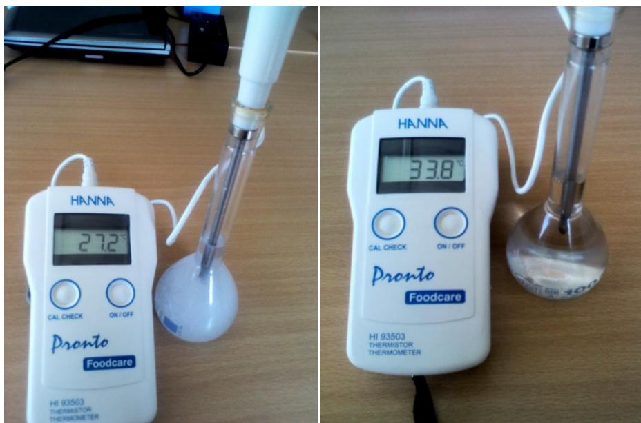
Εικόνα 4.4.1: (Αριστερά το ΥΑΦ στην αρχή αλλαγής φάσης. Δεξιά το ΥΑΦ σε υγρή μορφή [Zacharias Gkouskos (2012)])
